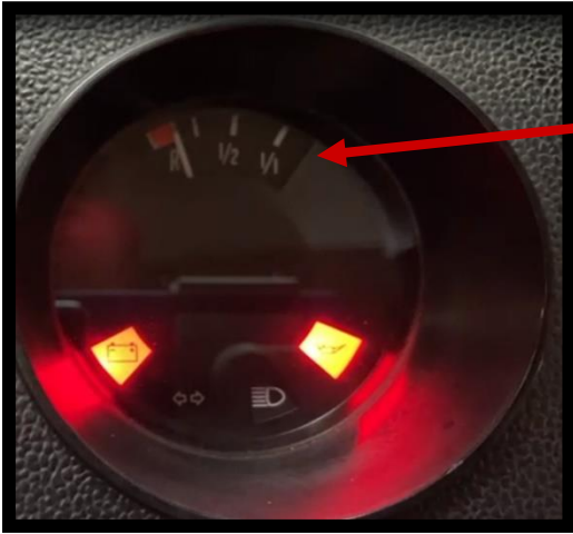
Loopt de meter uit de reserve zal de wijzerplaat van de Classic Evo Gauge GEEN Led indicatie meer geven
