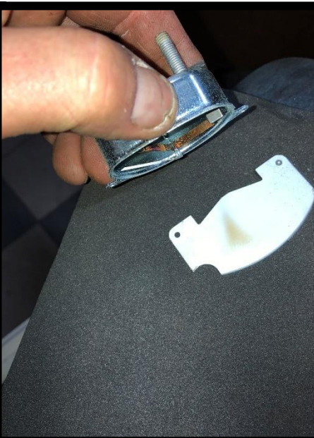
Het scherpje van de originele brandstofmeter zal worden gemonteerd op de nieuwe benzinemeter van Classic Evo Gauge®
