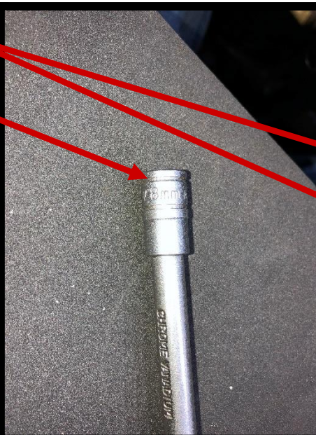
Nieuwe teller zover mogelijk naar beneden drukken, daarna op de schroeven met sleutel 8 vastzetten
