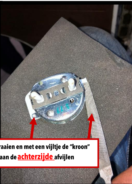
Nu VOORZICHTIG !!!! Het scherpje van de originele brandstofmeter demonteren met een kleine schroevendraaier
