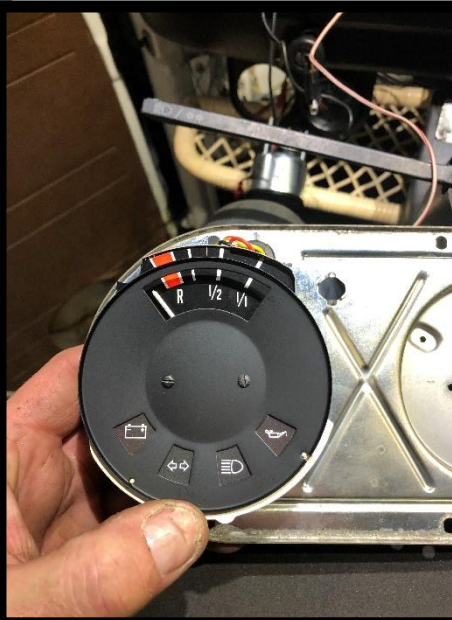
Afdekplaat van benzine meter terugplaatsen
