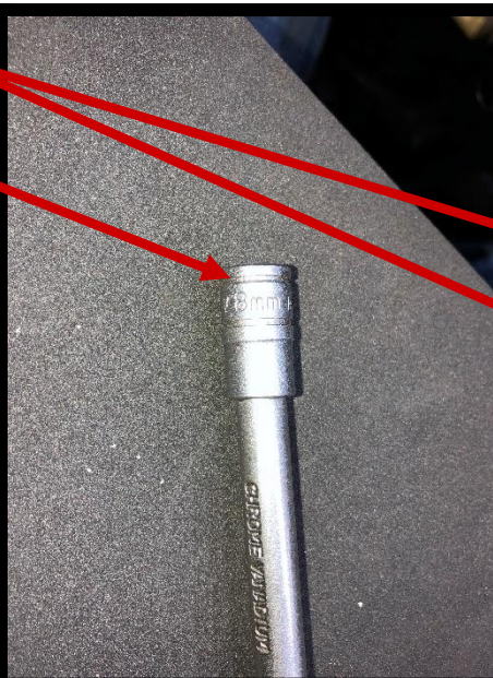
Den Classic Evo Gauge® so weit wie möglich nach unten Drücken und die M5-Schrauben mit einem 8-mm-schlüssel festziehen.
