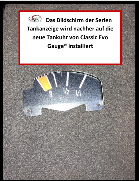
VORSICHT !!!! Das Bildschirm der Serien-Tankuhr mit einem kleinen Schraubendreher Entfernen.
