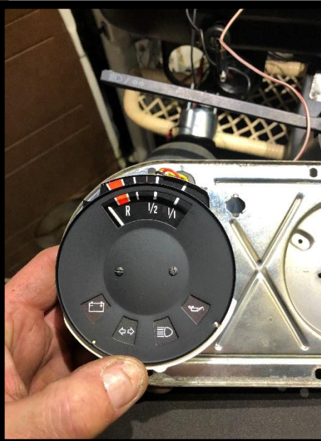
Abdeckung der Tankuhr wieder installieren
