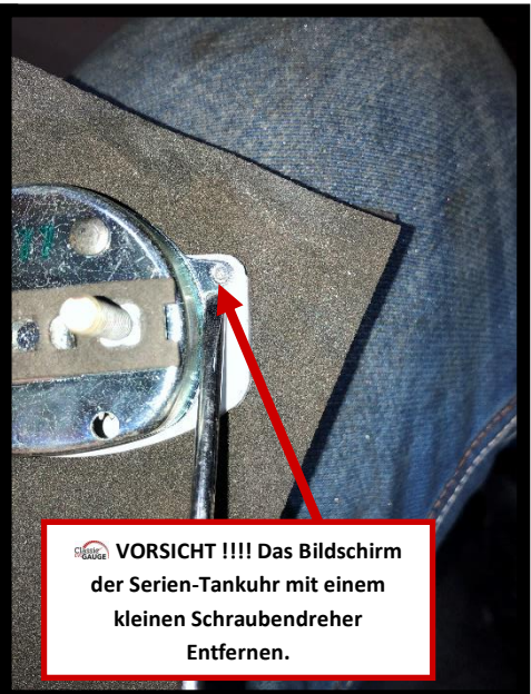
Das Bildschirm der Serien Tankanzeige wird nachher auf die neue Tankuhr von Classic Evo Gauge® installiert
