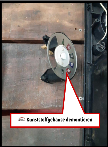
Die letzten 2 Schrauben der originalen Tankanzeige entfernen mit einem 10 mm Schlüssel und Anzeige entfernen.
