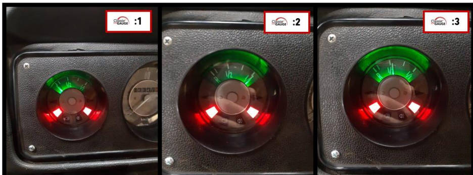
Der Classic Evo Gauge® läuft zuerst den Startphase durch (wie in der vorherigen Seite beschrieben) gefolgt von es einlernen die aktuell Tankschwimmer werte, gefolgt von einer BLAUE LED-Bestätigung
