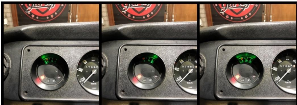
Der Classic Evo Gauge® läuft zuerst den Startphase durch (wie in der vorherigen Seite beschrieben) gefolgt von es einlernen die aktuell Tankschwimmer werte, gefolgt von einer BLAUE LED-Bestätigung
